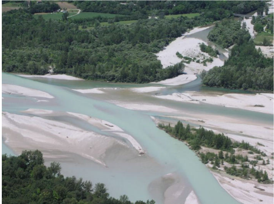
Bild 36: Einen Eindruck von der ursprünglichen Ausformung der Gewässerelemente gibt das Foto des Tagliamento eines naturbelassenen, dem Alpenrhein annähernd vergleichbaren Flusses. Der Alpenrhein besass vor der Regulierung infolge geringerer Geschiebe- und Abflussdynamik allerdings kleinflächigere, unbewachsene Schotterflächen und grösseren Anteil von Auwald im Gewässerbett.
